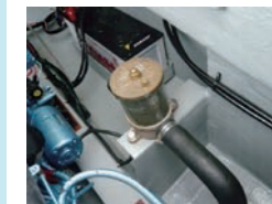
海水フィルタ (船体)
