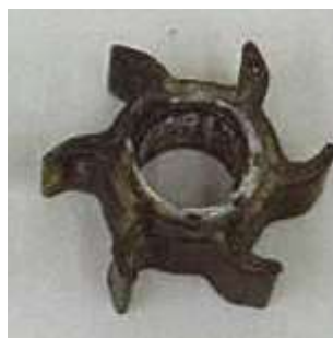
※劣化したインペラ
