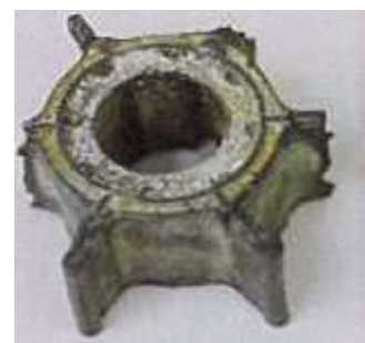
※破損したインペラ
