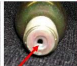
ボンベの封板
