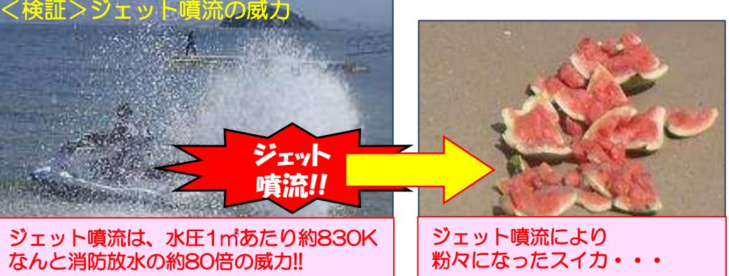
ジェット噴流は、水圧1mあたり約830KPaなど消防放水の約80倍の威力!!
