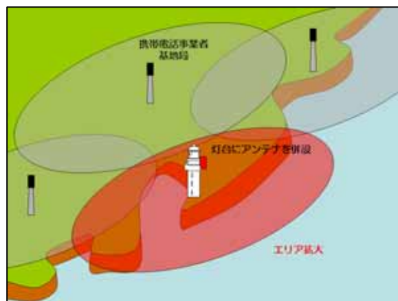
【海上保安庁施設へのアンテナ設置とエリアのイメージ図】
