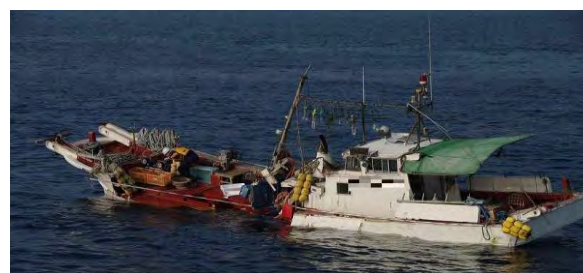
衝突し船体が破損した漁船
