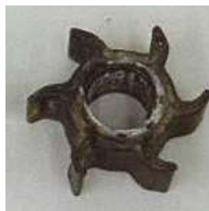
※劣化したインペラ
