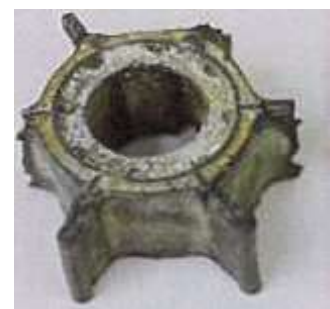
※破損したインペラ
