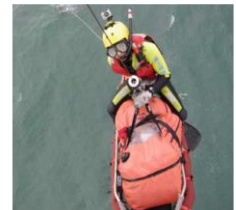
【密閉式担架：付随の空気ボンベで患者へ空気が供給できる海面搬送可能な防水型担架】
