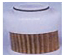
劣化した燃料フィルタ
