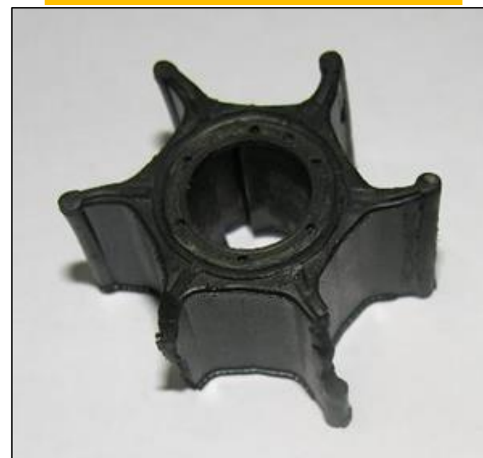
劣化した海水ポンプインペラ
