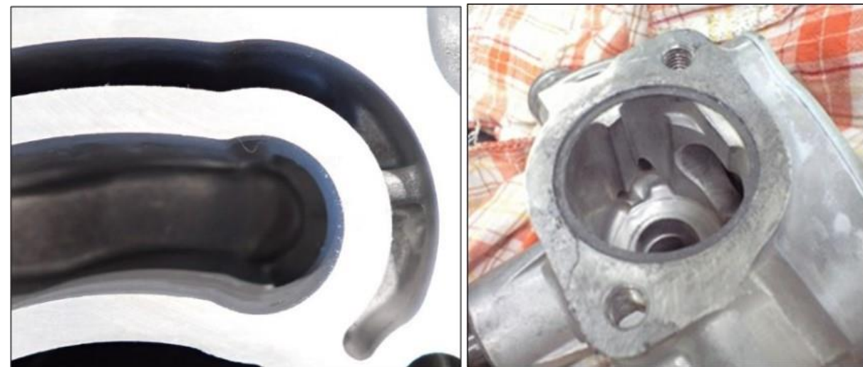
新品の冷却水通路
