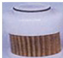
劣化した燃料フィルタ
